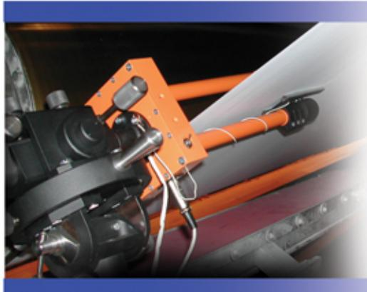
Конечной целью внесения любых изменений в текущий технологический процесс производства является поиск режима работы БДМ, обеспечивающего наилучшие показатели качества выпускаемой продукции. Собственная запатентованная разработка «БумТехно» система «ИПЛОНЕР» (Измеритель ПЛОтностной НЕРавномерности полотна) основанная на оптико-электронном методе, позволяет осуществлять фотометрирование движущегося полотна с целью количественной оценки его неоднородности как показателя качества.
